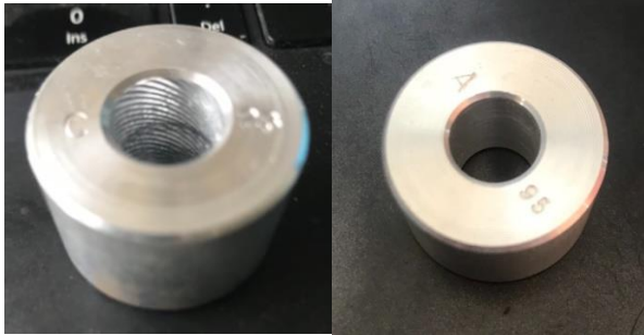
Hình 5.1: Thí nghiệm thu thập dữ liệu âm thanh với chỉ tiết rung động và ổn định khi tiện
