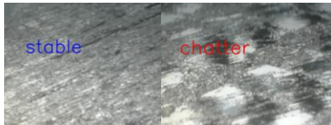
Hình 5.7: Nhận diện rung động trong quá trình gia công tiện
